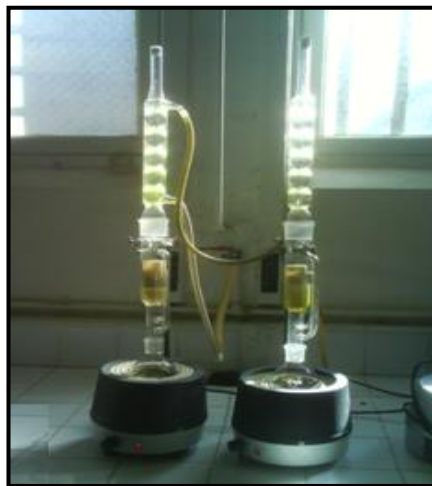
Figure 17: Montage de l'extraction solide-liquide par Soxhlet.
