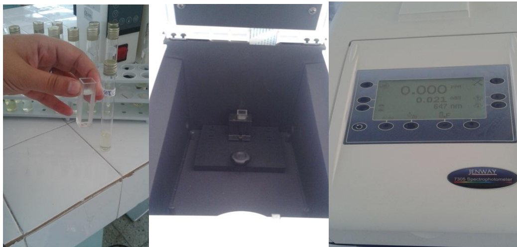
c)- Lecture des résultats à 647 et 663nm dans un spectrophotomètre -
