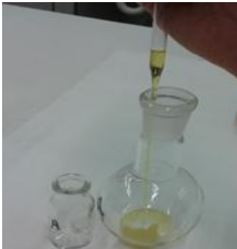
b)- Rinçage de la silice et récupération des métabolites -
