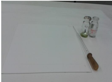
a)- Préparation de la plaque de silice et dépôt d'une fraction-
