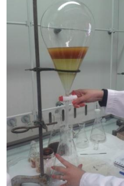
b)- Filtration de la phase aqueuse à travers une pompe à vide et du coton stérile -
