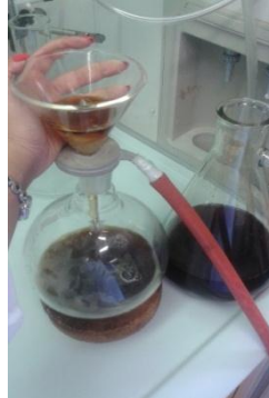
b)- Filtration de la phase aqueuse à travers une pompe à vide et du coton stérile -
