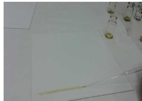
a)- Préparation de la plaque de silice et dépôt d'une fraction-
