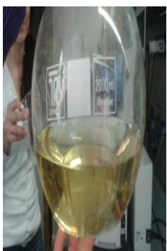
d)- Evaporation du dichlorométhane et obtention de l'extrait organique -
