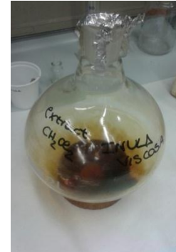
d)- Evaporation du dichlorométhane et obtention de l'extrait organique -
