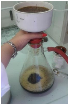
b)- Filtration de la phase aqueuse à travers une pompe à vide et du coton stérile -
