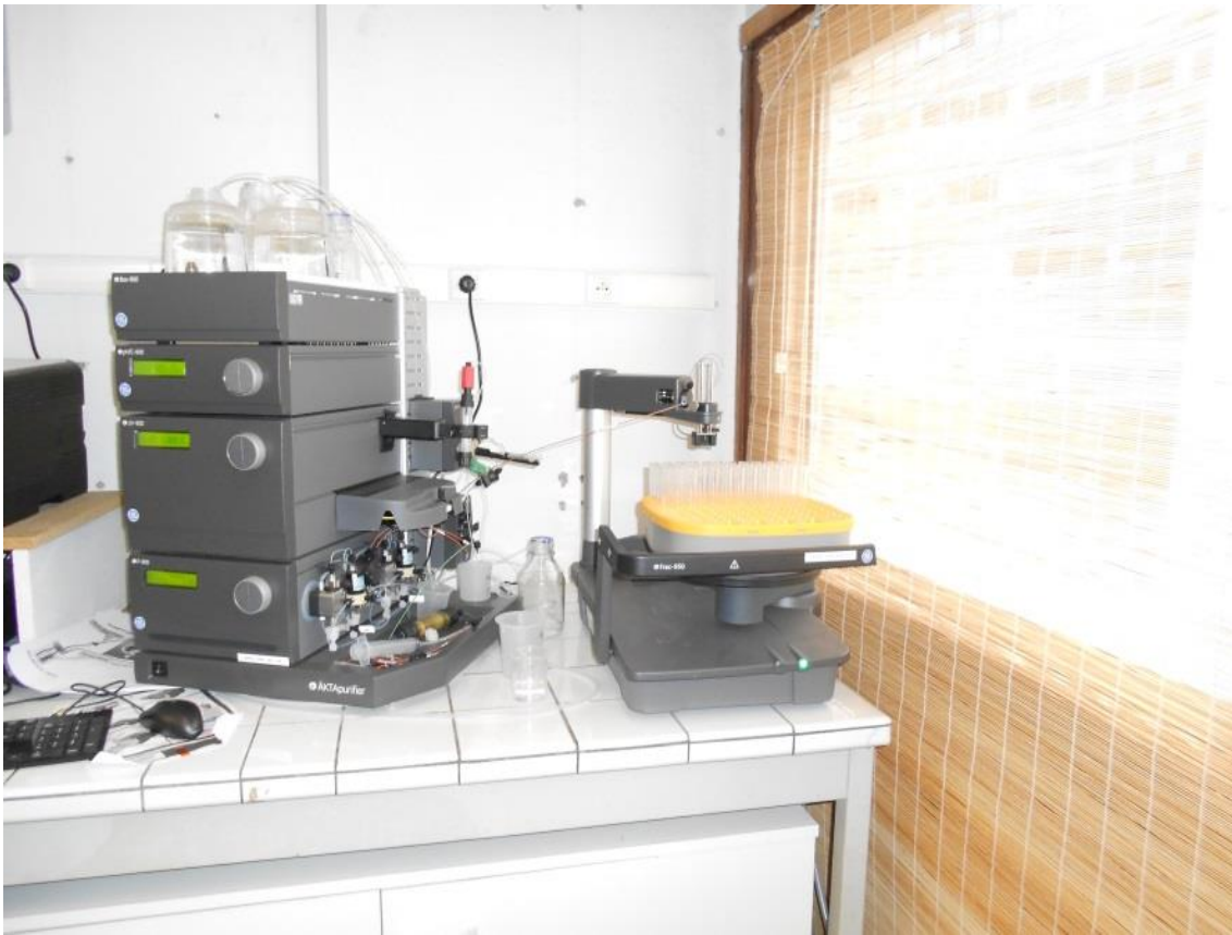
Photographie de l'appareillage de chromatographie liquide rapide des protéines (FPLC) semi-automatisé ÄKTA-Purifier.
