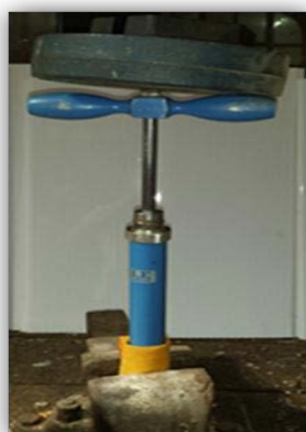
Figure 52: Etalonnage d'un pénétromètre
