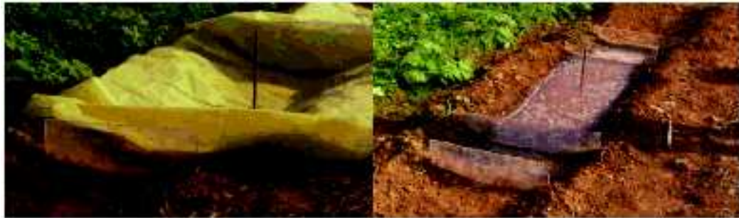
Photo 23 : Dispositif de mesure de l'infiltration dans un tronçon de seguia
