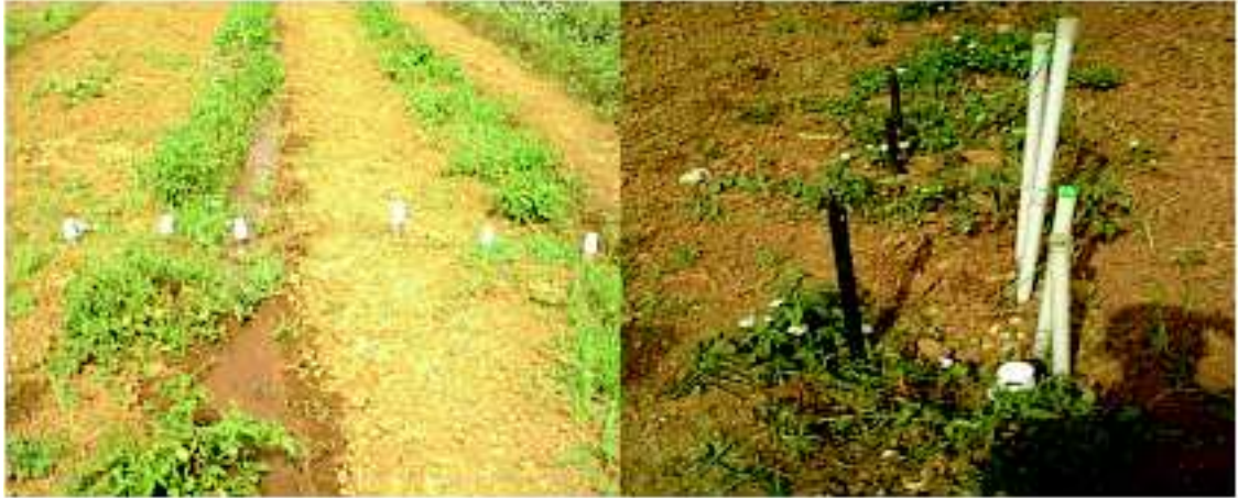
Photo 31 : Batterie transversale de tubes d'accès pour sonde à neutrons en site milieu de raie (gauche) et batterie de sondes Wattermark® en blanc sur site aval de raie (droite) ; essai 2000. Station INA
