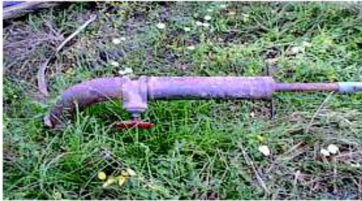
Photo 29 : Vanne à opercule pour l'alimentation en eau de la parcelle d'essai (1998 et 2000). Station INA
