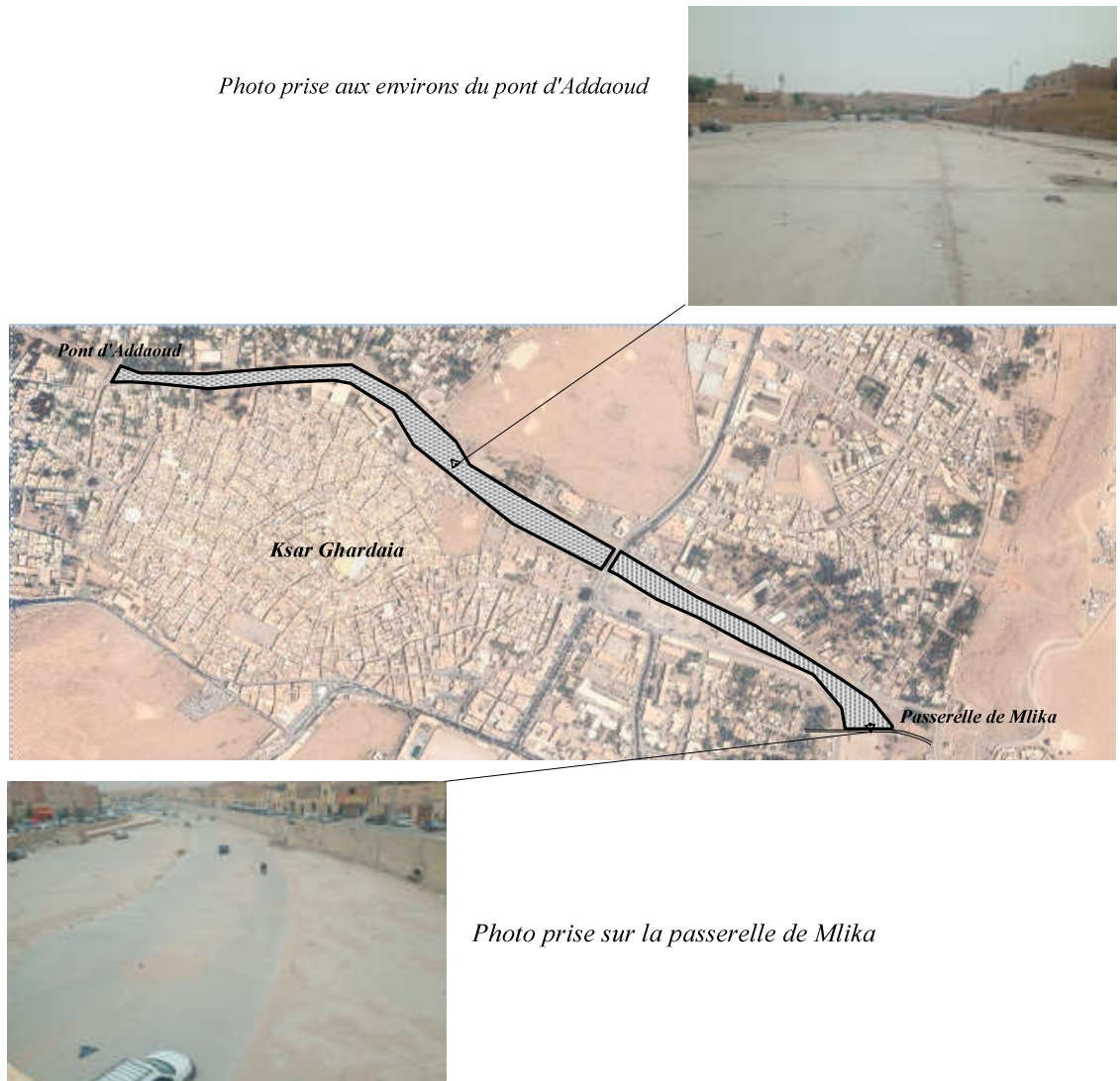
Figure VI.4: Dallage et Mure de soutènements en béton sur Oued M'Zab au centre ville de Ghardaïa
