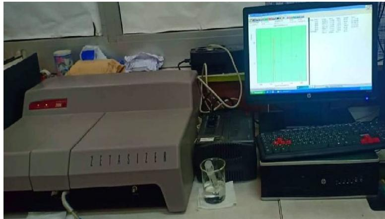
**Figure n°14:** Appareil de mesure du potentiel zêta (type *Zetamètre 2000*) des échantillons de laits emprésurés.
