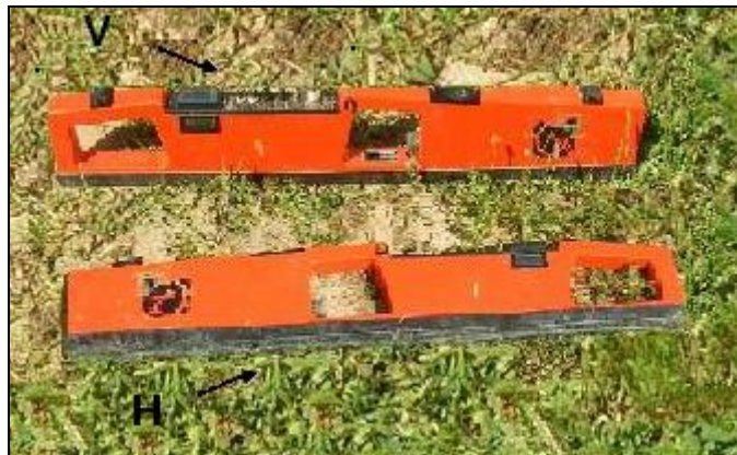
Figure 1-2. Conductimètre électromagnétique EM38 selon le mode vertical (V) (haut) et horizontal (H) (Bas)
