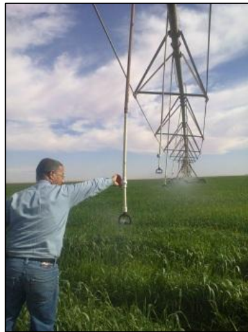
Figure 84: Une intervention en plein irrigation pour diminuer le débit sur la travée centrale en assurant les besoins en eau pour la dernière travée du pivot.
