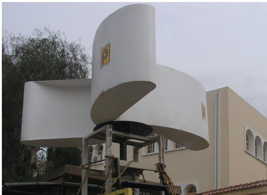
**Photo 4:** Prototype de l'éolienne à axe vertical et des pompes adaptées.
