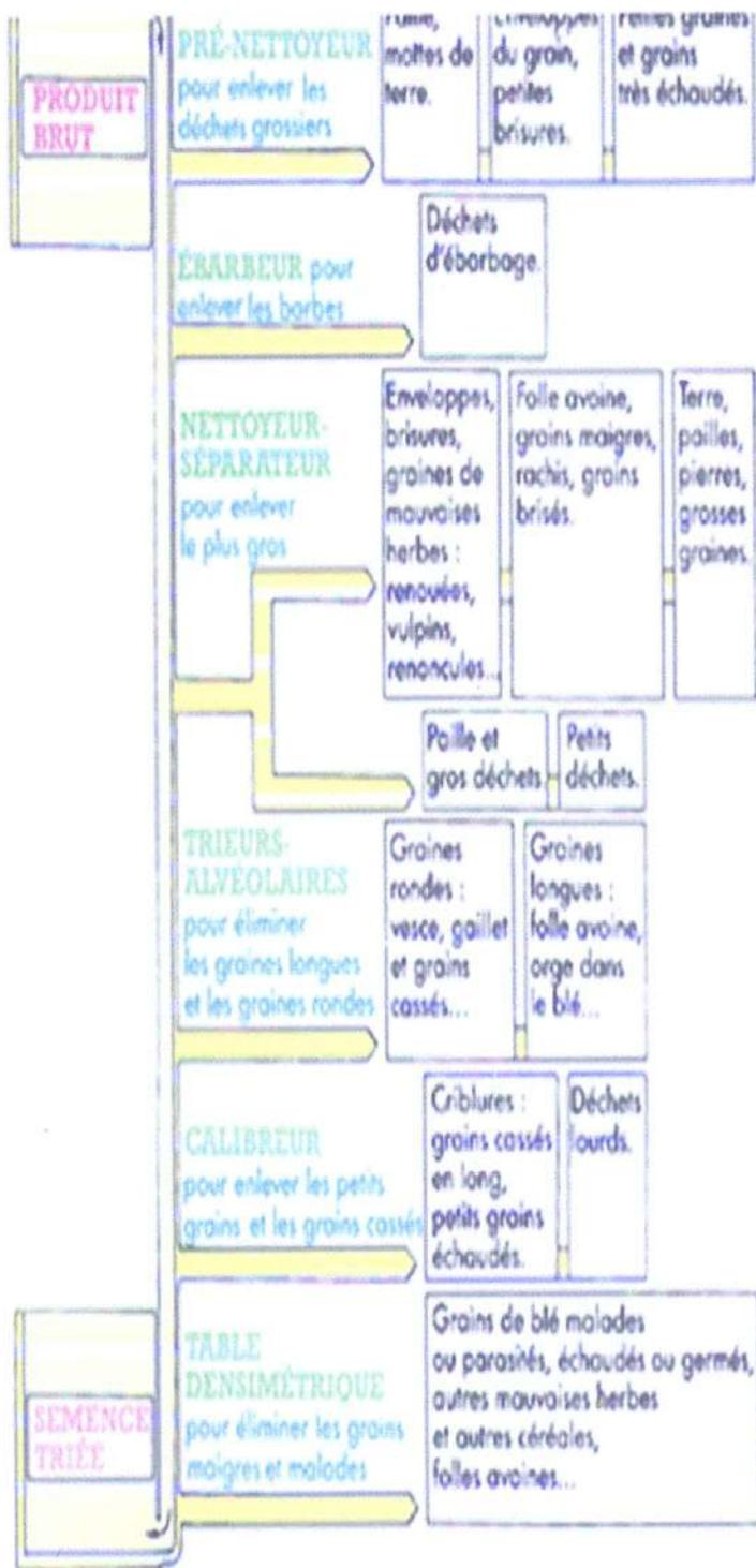
Figure 10 : La chaîne de traitement de semences du produit brut jusqu'à l'obtention de la semence triée et certifiée.
