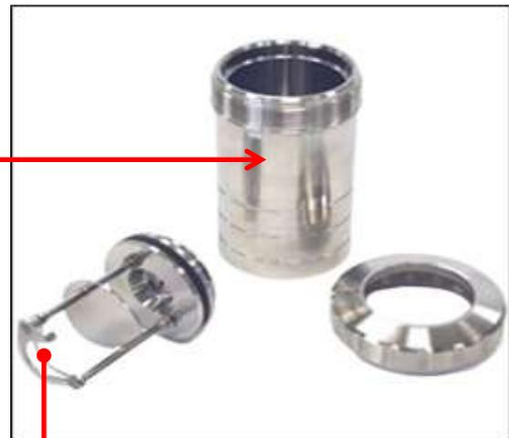
Figure 2 : Bombe calorimètre
