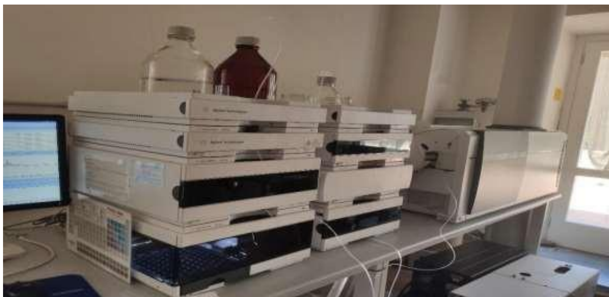
Figure 29. Appareil d'analyse LC-MS qTOF Agilent (6400) - API 3000.
