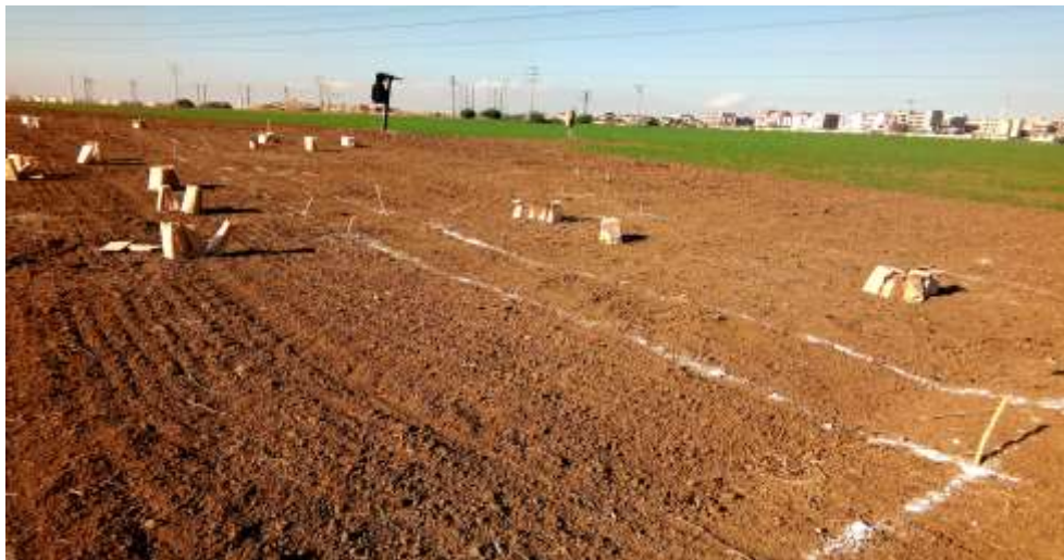
Figure 35: Prélèvement des échantillons du sol pour déterminer l'humidité du sol
