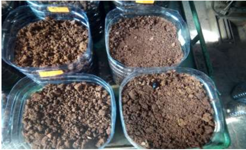
Figure 12: sols compactés en surface
