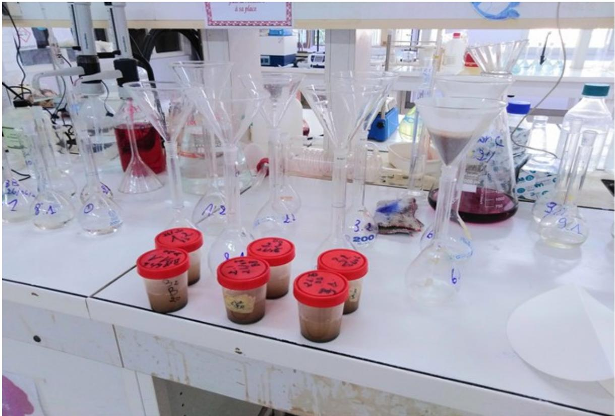
**Photo 7 :** Préparation des echontillons de sol pour analyses d'azote.
