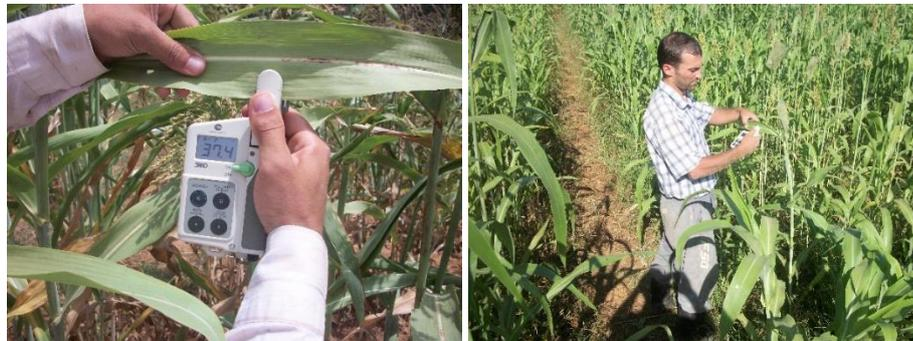
**Figure 22.** Estimation de la chlorophylle par l'appareil manuel électronique  $SPAD$ .
