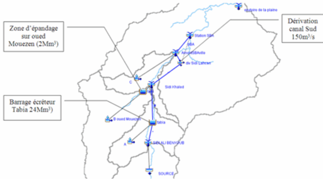
Figure 60: Schéma général du modèle hydrologique intégrant les aménagements de protection.
