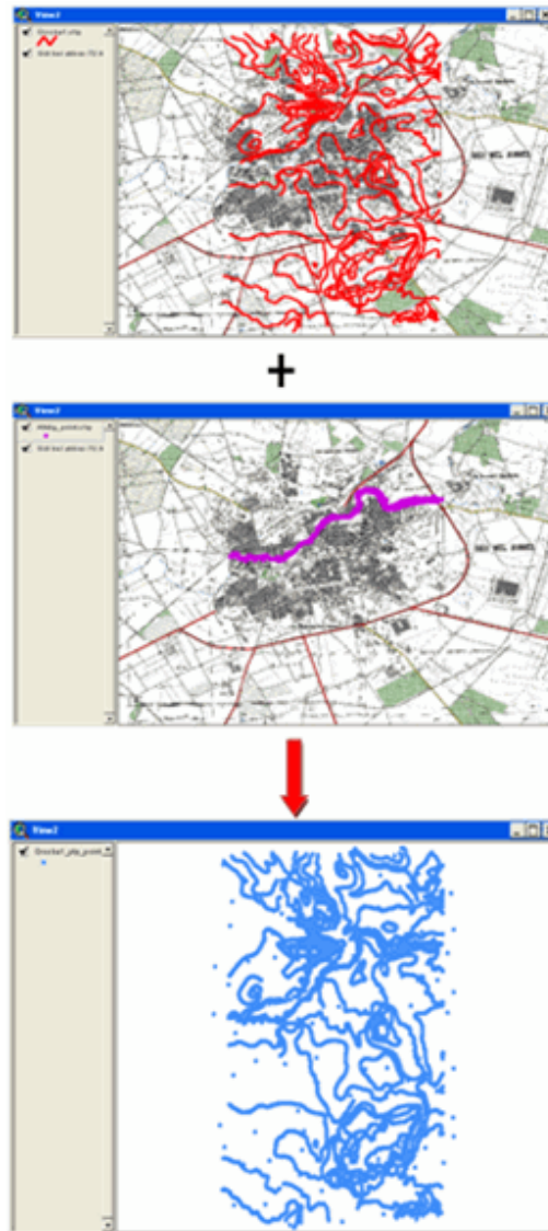
Figure 79: Combinaison de données topographiques de résolutions différentes.
