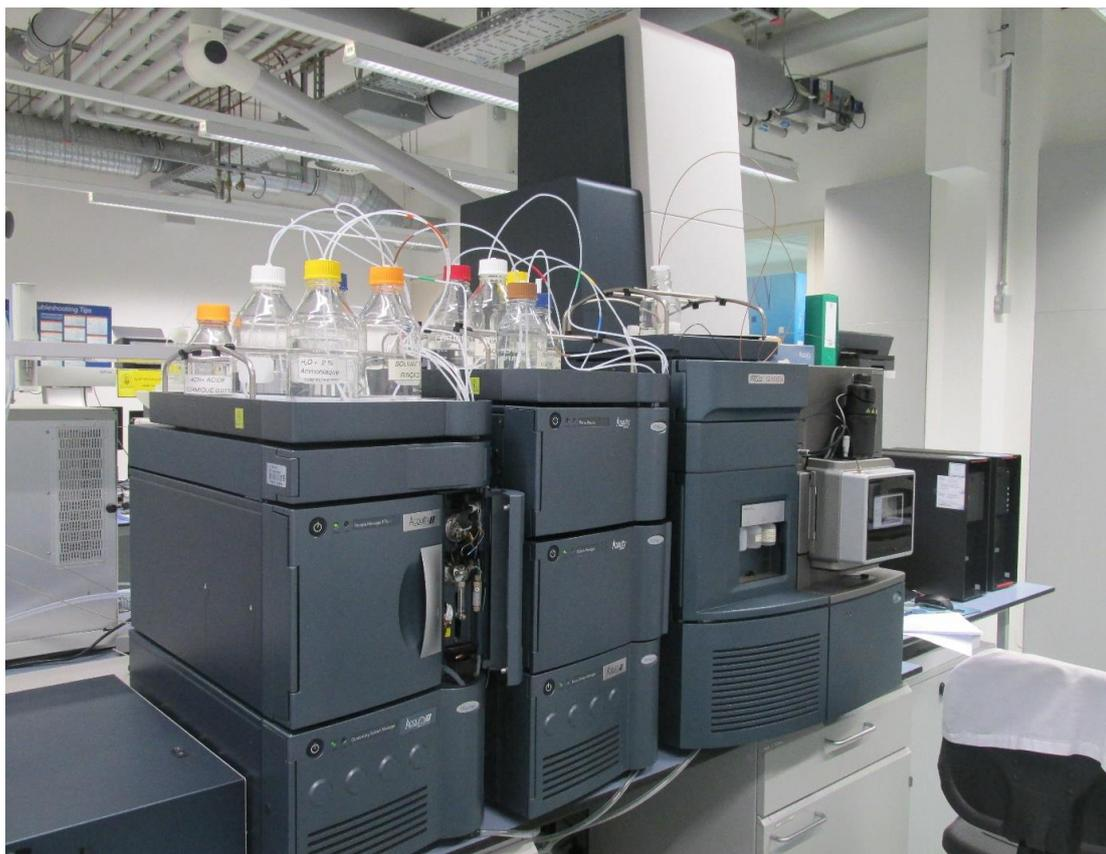
**Figure 15 :** Photographie d'équipement UHPLC-QTOF/MS
