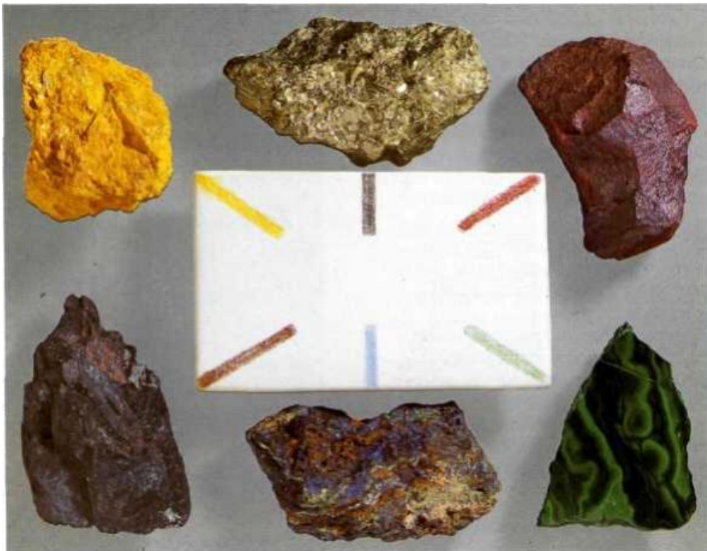
Fig. 1 : Couleur et trait de quelques minéraux. En haut, à partir de la gauche : orpiment, pyrite, cinabre. En bas, à partir de la gauche : hématite, azurite, malachite.
