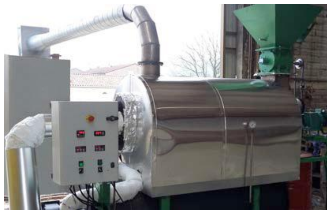
Fig o 10: Model d'un pyrolyseur industriel « CarboChar-3 » qui produit 5 tonnes de biochar par jour ( pro-natura@wanadoo.fr , 2016)
