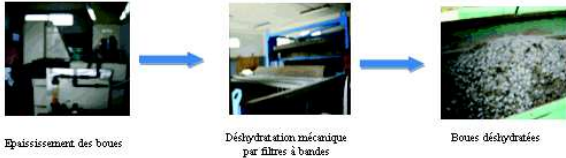
Figure 3. Les étapes de production de boues
