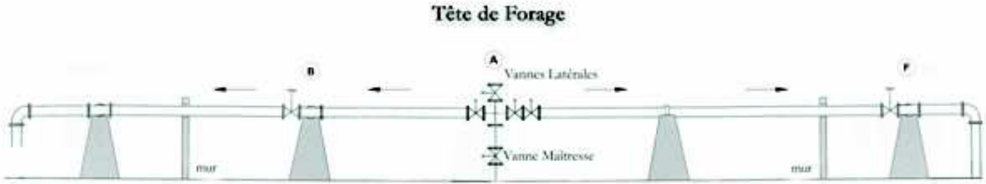
Figure 22 :Tête de forage – vue de face.
