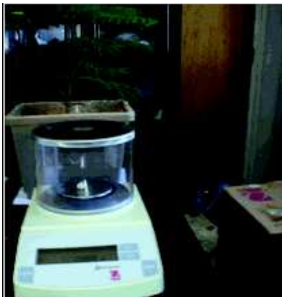
Figure 9 b - Balance de précision à 1/1000 ème de gramme pour peser œufs.
