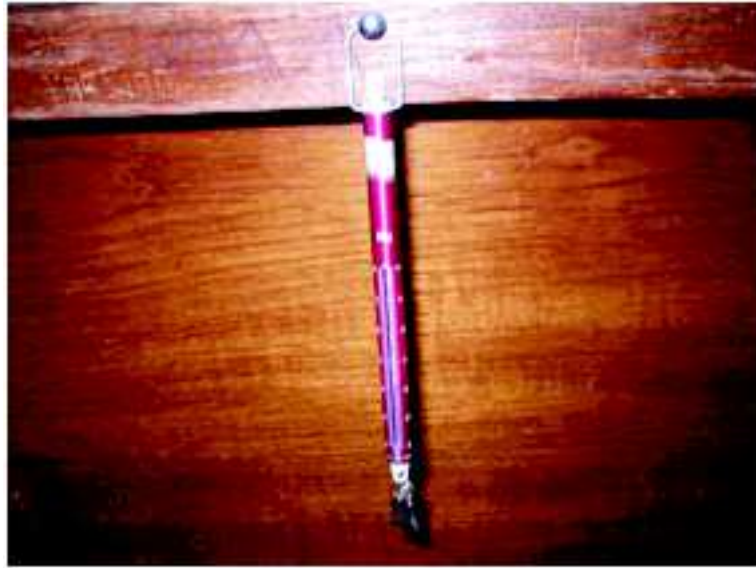
Figure 9 c. - pesola de précision de 1/100^{\text{ème}} de gramme pour peser les oisillons.
