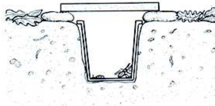
Figure 13: Schéma d'un pot barber installé dans le sol.
