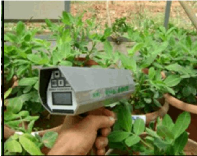
**Figure 8** : Mesure de la température du couvert végétal par le thermomètre infrarouge
