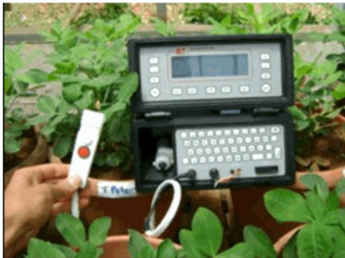
**Figure 7** : Mesure de la résistance stomatique à l'aide d'un poromètre
