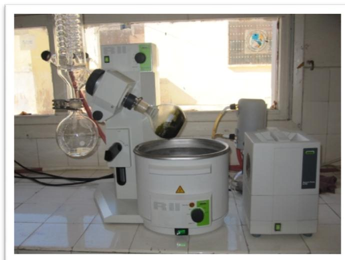
**Figure n° 19:** Evaporation du solvant (éthanol) à l'évaporateur rotatif.
