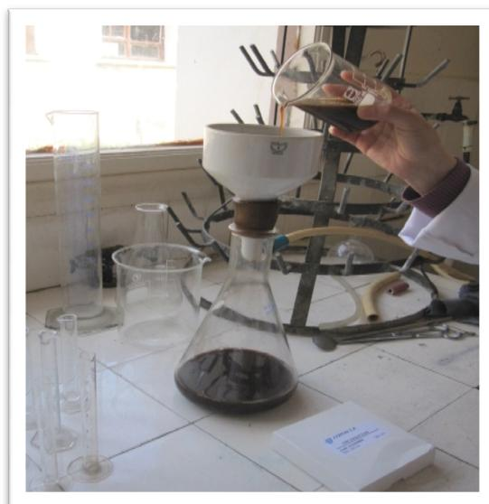
**Figure n° 20:** Filtration du macéré aqueux à l'aide d'un Büchner.
