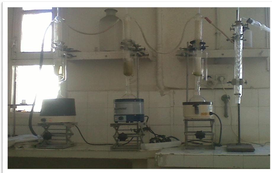
**Figure n° 18:** Dispositif de l'extraction solide liquide.
