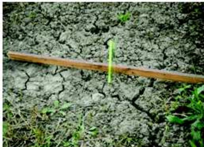
*Photo 6. Dispositif de mesure du microrelief gilgai au terrain*
