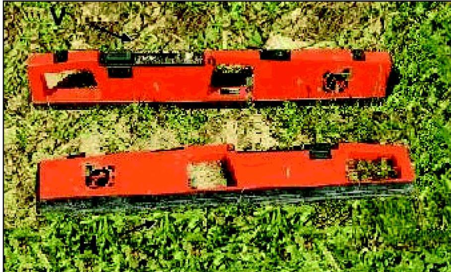
*Figure 2 : Conductivimètre électromagnétique EM-38 selon le mode vertical (V) et horizontal (H)*
