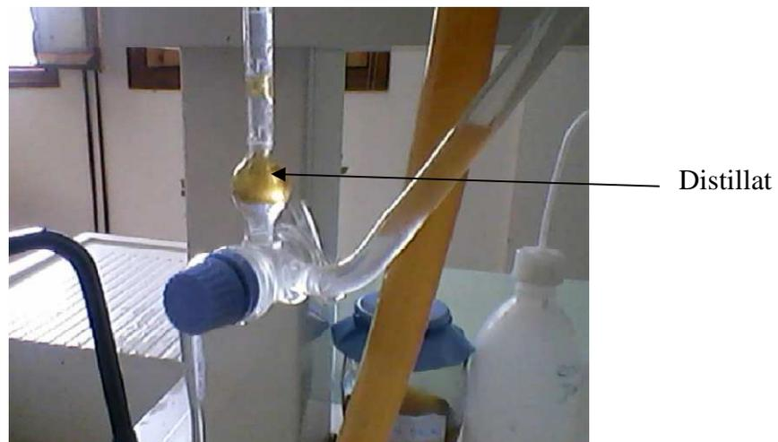
Figure 6. - Dispositif de récupération de l'huile essentielle
