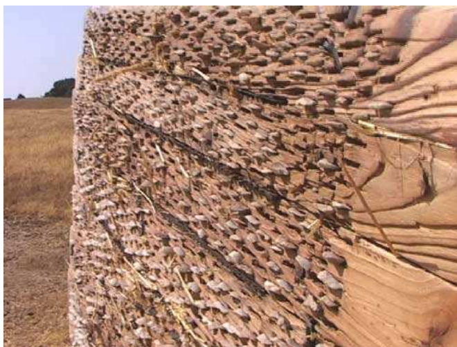
Figure 37: face inférieure du traîneau à dépiquer (Anonyme 3, 2008)
