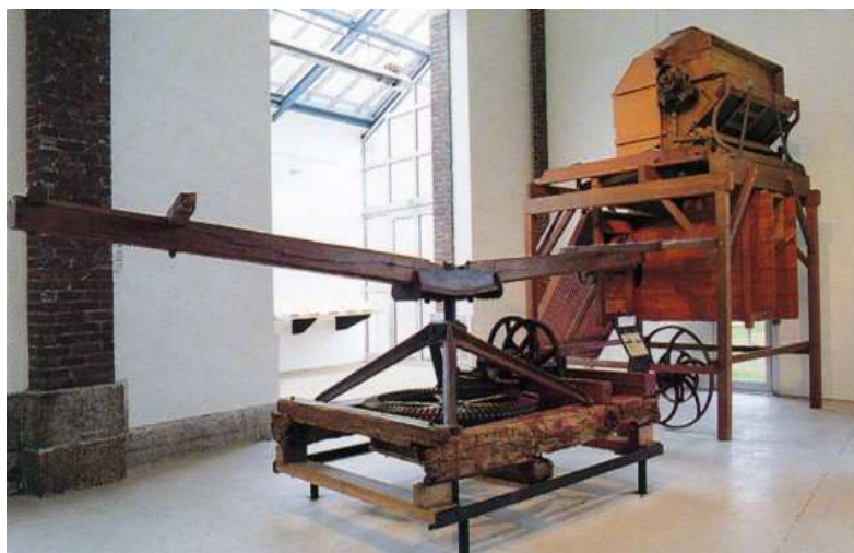
Figure 43: Batteuse à manège (Anonyme 1b, 2008)
