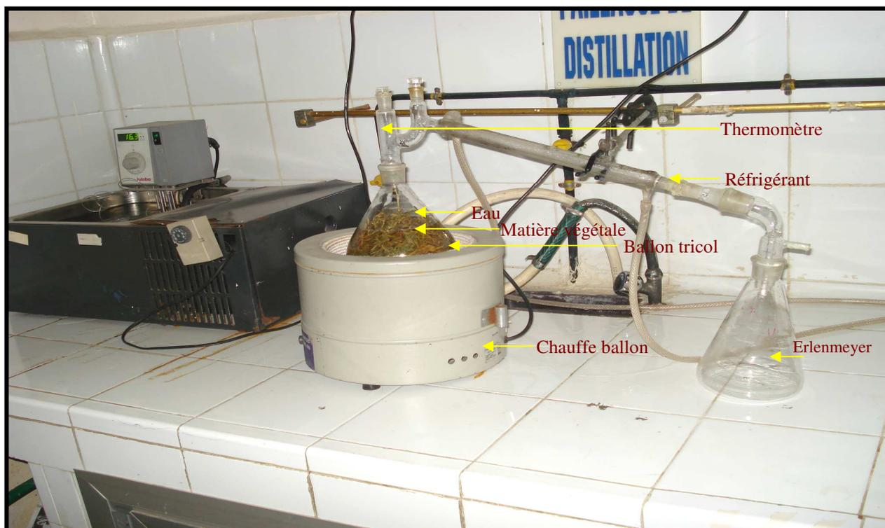
**Figure 4 :** Extraction de l'huile essentielle par hydrodistillation (original)
