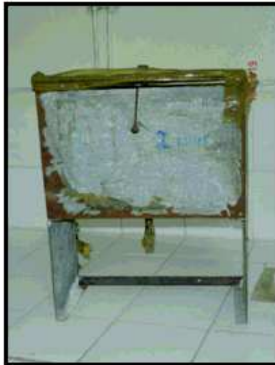
Figure 2. Dispositif utilisé pour traiter en laboratoire la paille à l'ammoniac
