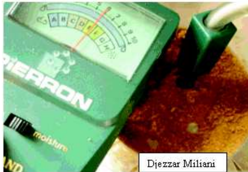
Figure n°13 : Mesure du taux d'hygrométrie du substrat de ponte (sable)
