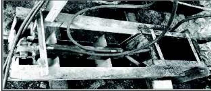
Figure 2 : Presse hydraulique pour la fabrication des blocs (Miller et Thompson, 2003).
