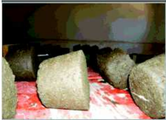
Figure 4 : Blocs démoulés en cours de séchage
