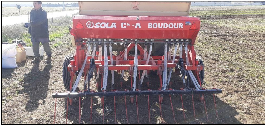
Figure 8: Semoir « BOUDOUR » de CMA-SOLA.(ITGC SETIF)
