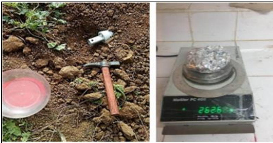
Figure 24: Méthode de prélèvement du sol et de calcul de la densité apparente du sol
