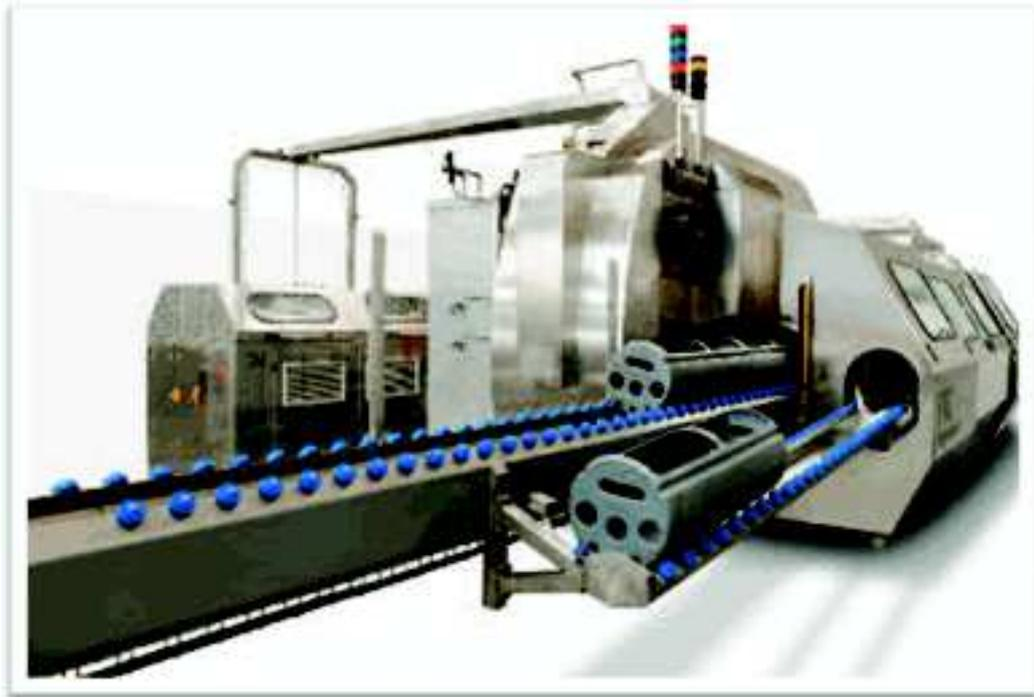
Figure I.6: Exemple d'équipement haute pression industriel, Promatec, Belgique (Calders, 2009).
