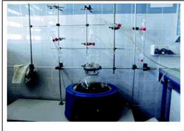
Figure 13 - Montage de l'appareil Clevenger- modifié.
