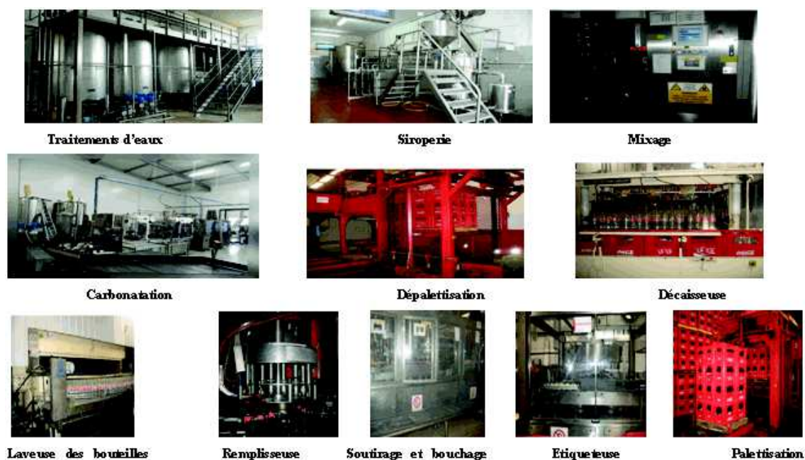
Fig n°32 : Quelques équipements de la chaîne de fabrication d'une boisson gazeuse dans les entreprises enquêtées
